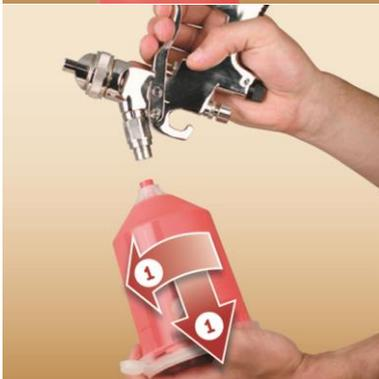
Becher durch Drehen und gleichzeitiges Ziehen entfernen.
