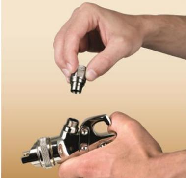
Passenden Schraubadapter an der Spritzpistole befestigen (siehe Adapterliste).
