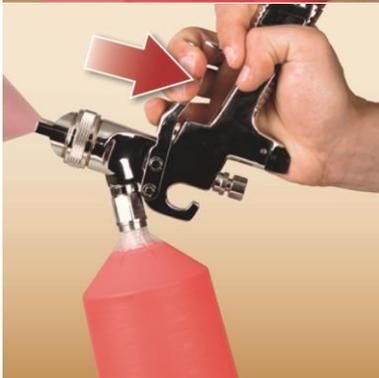
Spritzpistole um 180° drehen. Abzugsbügel der Pistole kurz betätigen, damit die Farbe aus dem Farbkanal der Pistole entweichen kann.
